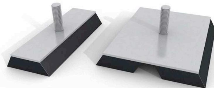
Supporti elastici costituiti da uno o due elementi in gomma vulcanizzati ad una piastra metallica superiore provvista di bullone per l'ancoraggio alla macchina. L'aderenza al terreno è data dal peso della macchina.
