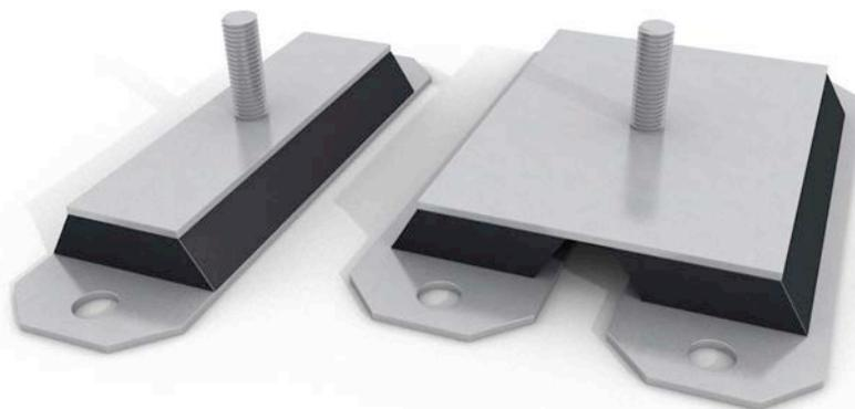
Supporti elastici strutturalmente identici agli APAMA, con la sola differenza che l'elemento o i due elementi in gomma sono vulcanizzati ad una ulteriore piastra metallica inferiore provvista di fori per l'ancoraggio al terreno.
