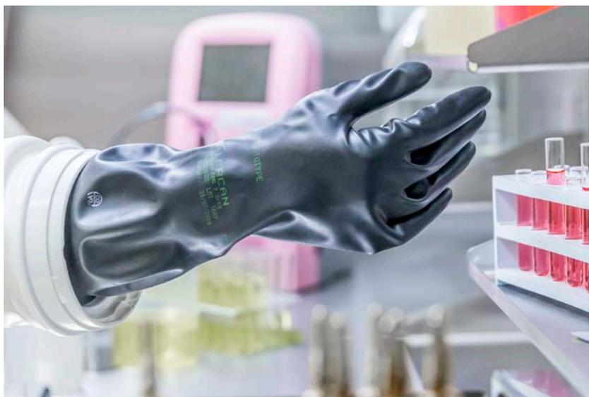
Guanti "corti" da accoppiare alle MANICHETTE. Questa scelta permette il cambio rapido della sola estremità del guanto: per utilizzare la taglia più idonea in base alla mano dell'operatore o sostituire il guanto che va a contatto coi prodotti quando avviene un cambio delle sostanze da manipolare.
