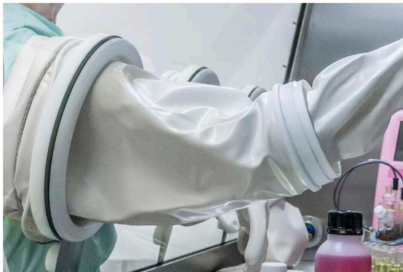
È stata sviluppata una linea completa di manichette con ampi diametri per un maggior comfort o per adeguarsi meglio all'uso da parte di persone con caratteristiche somatiche differenti.
