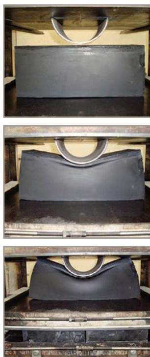
Dimostrazione della maggior rigidità dei Parabordi COMPOSITI
